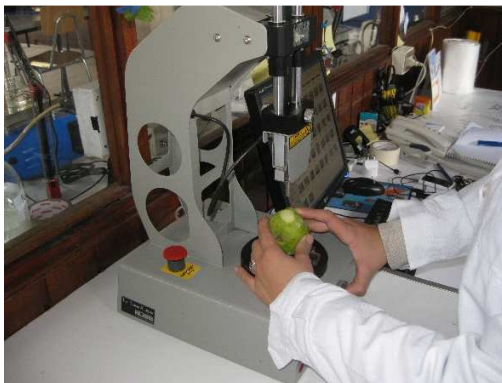
Figura 2. Medición de la textura en peras var. Packham's Triumph con penetrómetro motorizado FTA.
