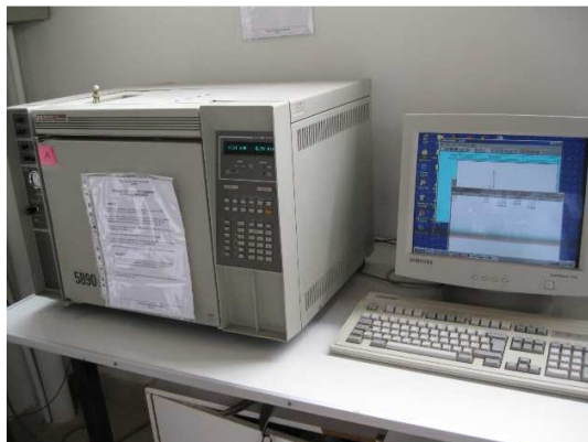
Figura 3. Cromatógrafo de gases Hewlett Packard 5890 utilizado para el análisis de la tasa respiratoria de cascós y cubos de pera var. Packham's Triumph.
