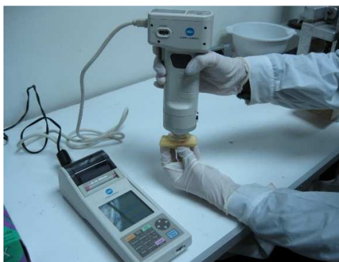
Figura 4. Medición del color en peras var. Packham's Triumph con colorímetro portátil.
