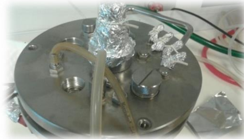
Figura 10: salidas del reactor que deben ser selladas
