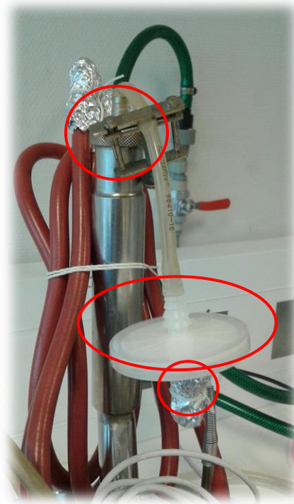
Figura 13: Mangueras selladas conectadas al condensador del biorreactor
