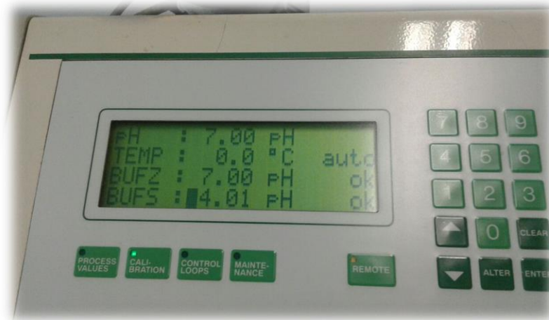
Figura 15: panel digital del controlador del biorreactor
