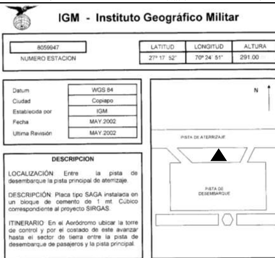
Figura 2.7. Ubicación de la estación gravimétrica en el aeropuerto Chamonate de la ciudad de Copiapó (Triángulo sólido).
