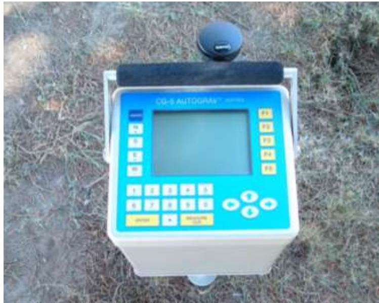
Figura 1.4. Gravímetro Scintrex modelo CG5. Este gravímetro, fabricado por la empresa Canadiense Scintrex, posee una resolución de un microgal, y entre otras cosas incluye corrección por mareas, corrección continua de inclinación, filtro sísmico y GPS integrado.
