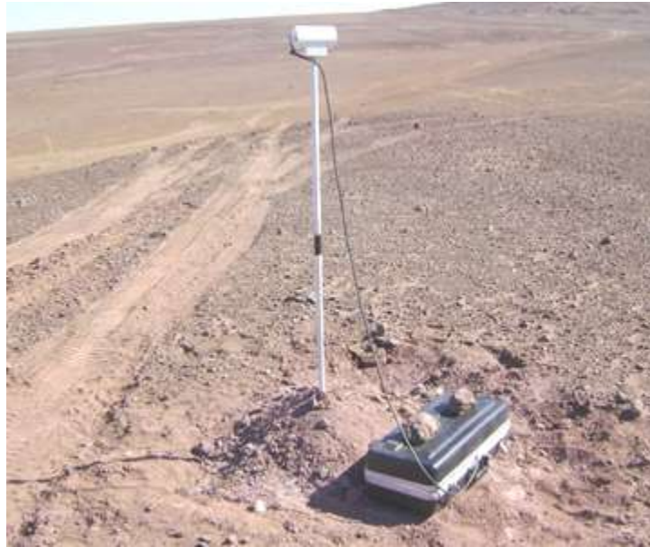
Figura 2.4. Magnetómetro Geometrics Modelo G856 en la estación base ( 27^{\circ} 49' 09.52''S , 70^{\circ} 31' 08.04''W , elevación = 463m), con su sensor instalado sobre un bastón de aluminio de 2 metros de altura. La unidad graba automáticamente la medición del campo total cada 30 segundos. Según el IGRF (Internacional Geomagnetic Reference Field) para los días 21 al 26 de mayo de 2008 en que se realizaron las mediciones, en la estación base la intensidad promedio del campo magnético fue de 23477.7 nT, con una inclinación de -26.842^{\circ} y declinación de -0.375^{\circ} .
