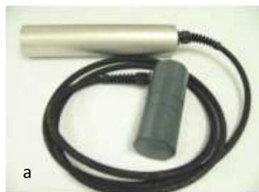
Figura 2.2a. Sensor de vapores de cesio (cilindro negro), y sistema de amplificación electrónica color gris, Figura 2.2b Computador y consola de comando.
