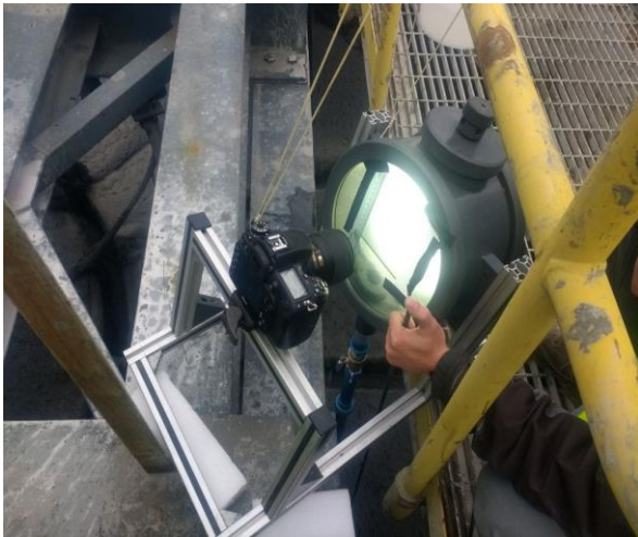
Figura 134 Utilización de equipo Bubble Viewer en etapa de toma de imágenes de burbujas
