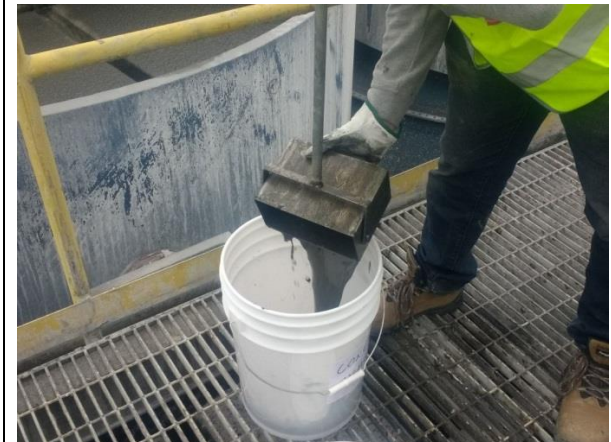
Figura 137 Recolección de muestra mediante muestreador de concentrado
