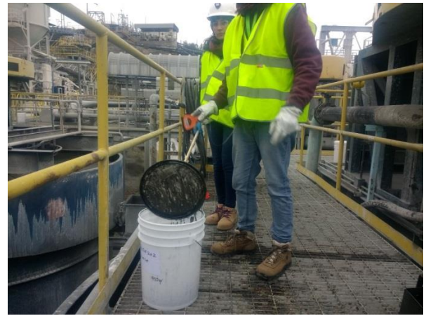
Figura 139 Recolección de muestra tomada mediante muestreador de Top of Froth
