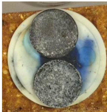
Figura 4.5: Pastillas de \text{La}_{0.6}\text{Sr}_{0.4}\text{Mn}_{0.1}\text{Fe}_{0.9}\text{O}_{3-\delta} y \text{La}_{0.6}\text{Sr}_{0.4}\text{FeO}_3 sobre un crisol, dispuesto sobre un ladrillo refractario antes de entrar al proceso de sinterizado.
