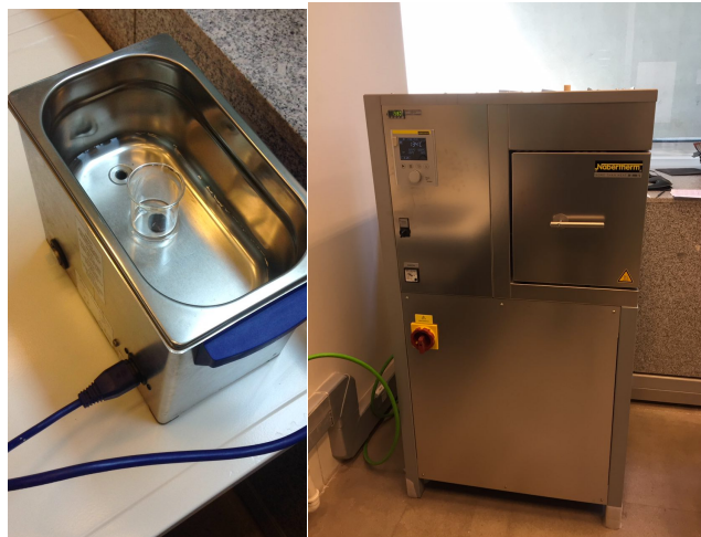
Figura 4.7: Limpieza de pieza en tina de ultrasonido. Figura 4.8: Horno Nabertherm utilizado en tratamientos térmicos.
