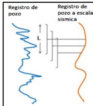
Figura 4.3: Técnica de Backus (1962). Esta técnica escala propiedades elásticas de la roca observadas en pozo para obtener valores de velocidad V_P y V_S en escala sísmica, mediante una ventana de escalamiento de longitud L (modificado de Lindsay y Van Koughnet, 2001).
