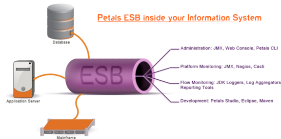
Figura 2.2: Diagrama básico de arquitectura de petals
