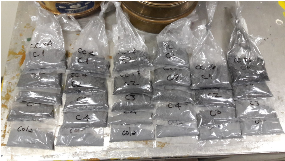
Figura 46: Bolsas con producto de pruebas. Notar que el material es más oscuro en las bolsas superiores (concentrado preflotación o primer concentrado de flotación de cobre) y más claro en las bolsas inferiores (colas), indicando que el sólido se va empobreciendo en carbono orgánico.
