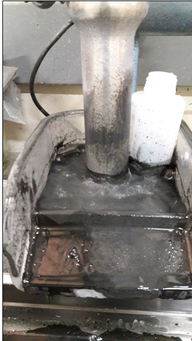
Figura 25: Celda de flotación durante preflotación, mostrando un envase de plástico semi-sumergido con el fin que la celda rebose y evacúe el carbono orgánico.
