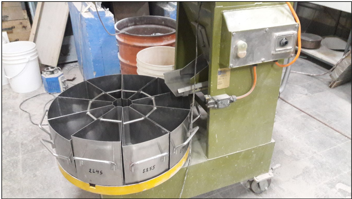
Figura 17: Carrusel de 10 compartimentos, utilizado para formar los paquetes de mineral para cada prueba.
