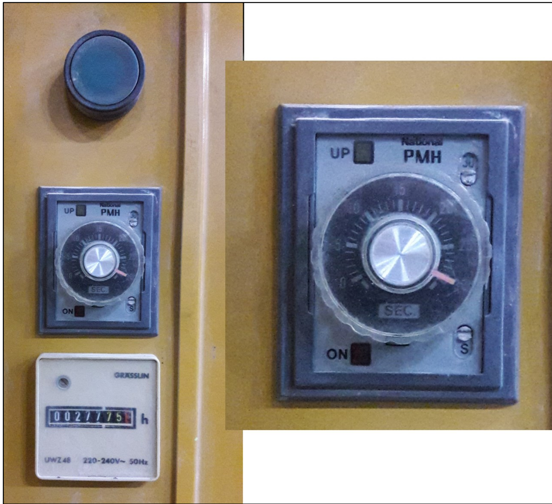
Figura 20: Panel de control del pulverizador. El botón verde corresponde al interruptor de partida. Al centro está el timer con dos interruptores: escala de 0 a 3 o de 0 a 30 (derecha arriba), y minutos o segundos (derecha abajo). En la parte inferior está el horómetro del equipo.
