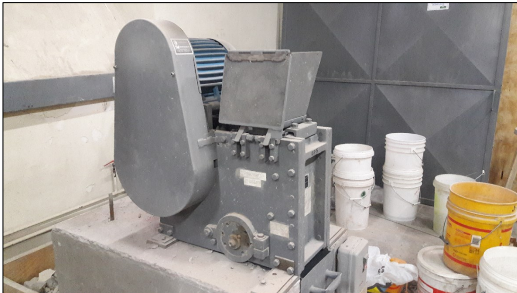
Figura 16: Chancador de mandíbulas utilizado para la segunda reducción de tamaño.
