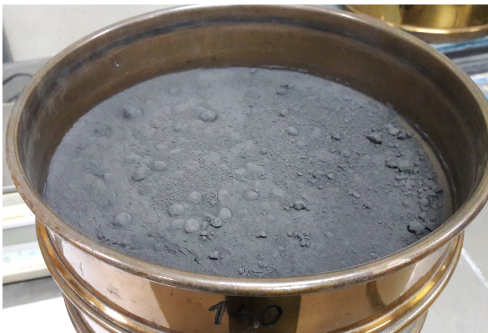
Figura 21: Tamizaje en seco. Se observa la formación de glómeros, impidiendo una buena clasificación de las partículas finas
