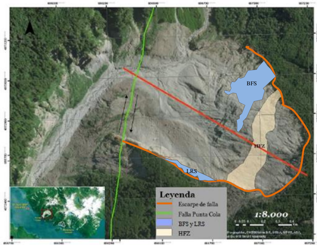
Ilustración 18: Vista en planta del deslizamiento de Punta Cola y las estructuras mayores consideradas en el modelo: Falla Punta Cola (línea verde), HFZ (zona beige). Además, se muestran la Superficie de falla basal (BFS) y Superficie lateral de liberación (LRS). Fuente: (Modificado) Escudero. 2017
