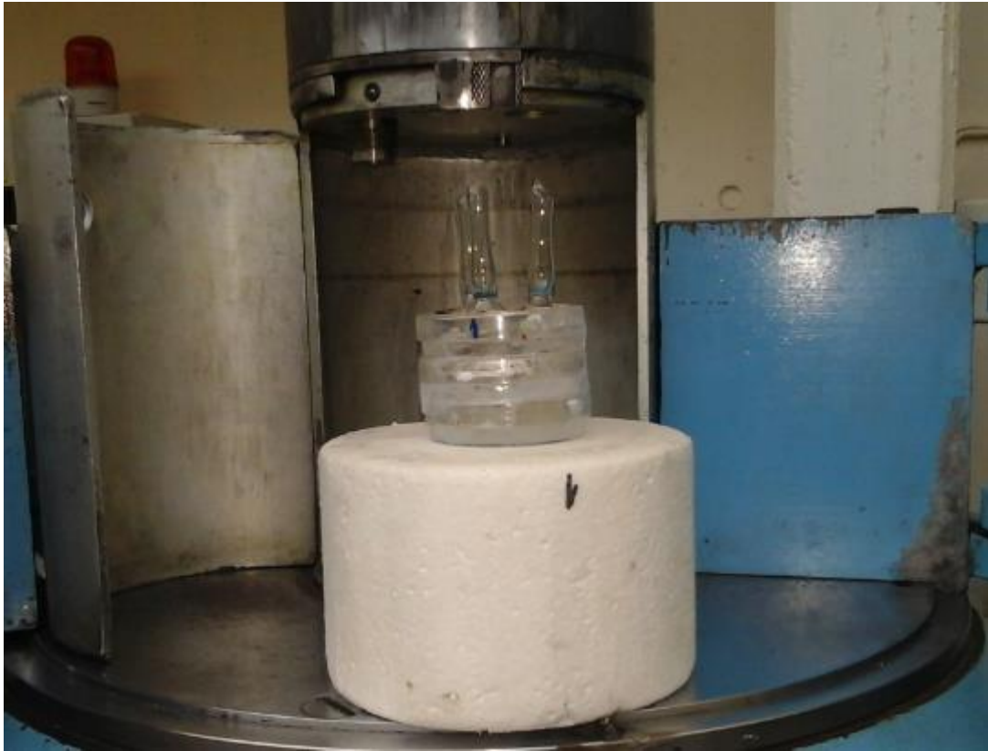
Figura 1. Posición de los dosímetros en placas en que posteriormente se ubicaron los explantes irradiados.
