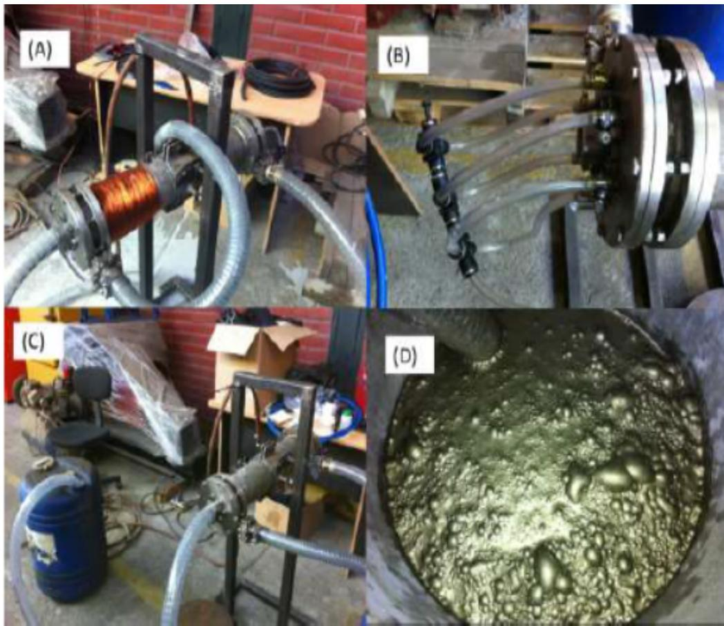
Figura 4.3: Fotografías del prototipo de la nueva celda de flotación (A), detalle del ingreso de aire la celda (B), sistema global implementado (C) y concentrado final resultante del proceso (D).
