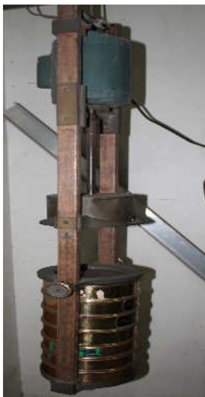
Figura 3.6: Estación de tamizado.
