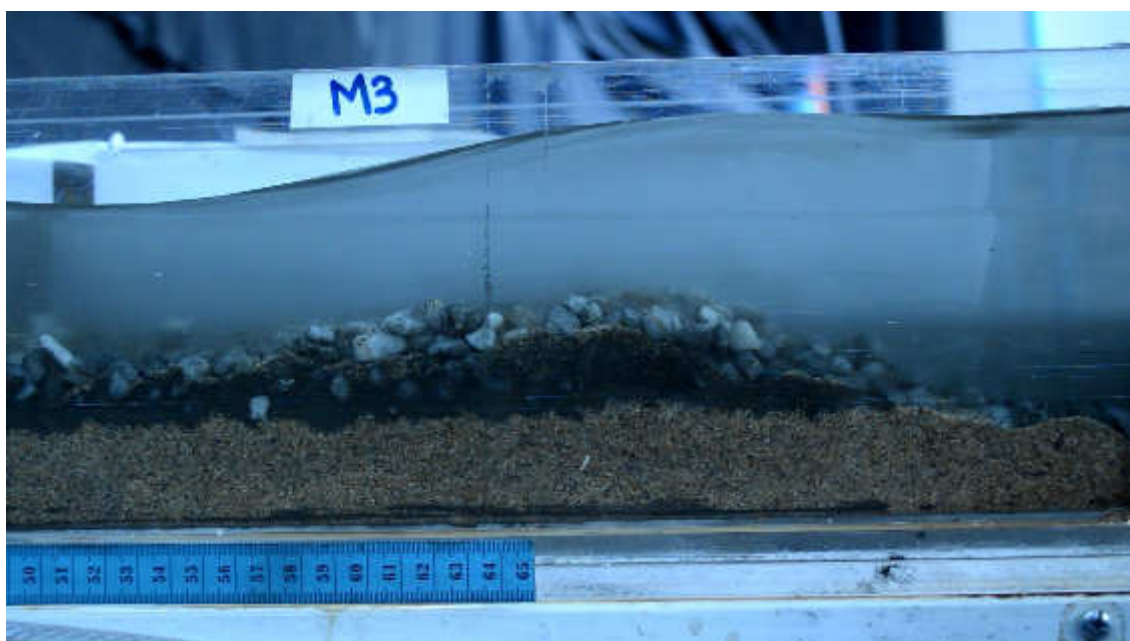
Figura 5.5: Estado final de la infiltración. Experiencia con compuerta
