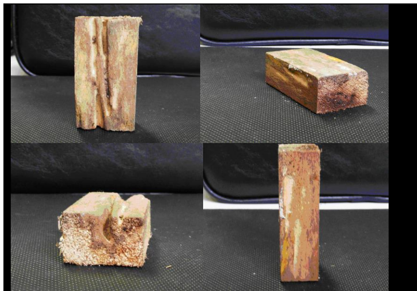
Figura 9. Probetas de álamo (PS) con grado de ataque 4 en microprueba de campo 1.
