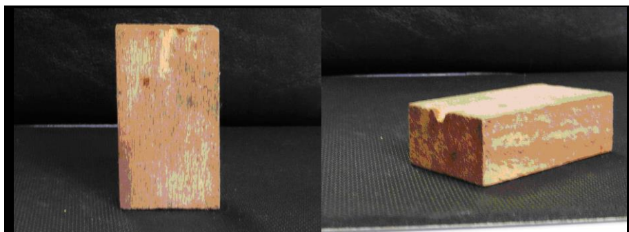
Figura 10. Probetas de canelo (DW) con grado de ataque 2 en microprueba de campo1.
