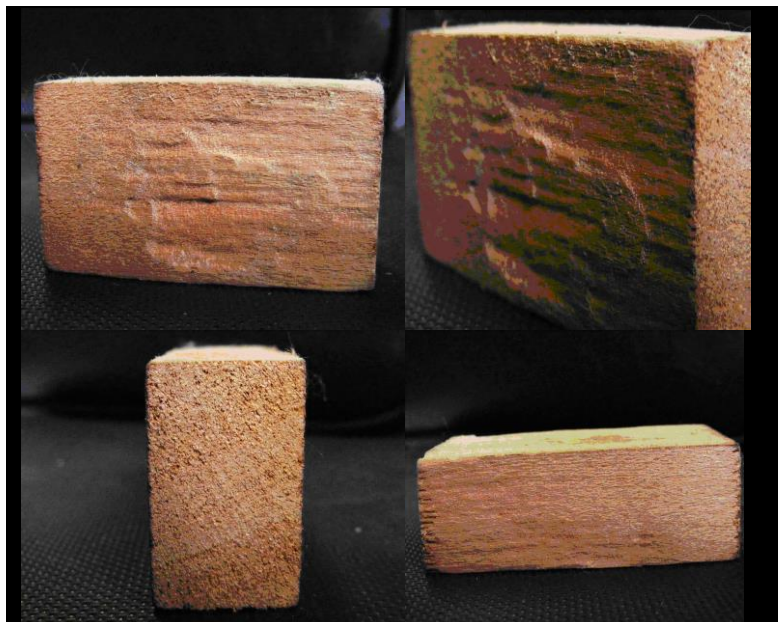
Figura 7. Probetas de raulí (NA) con ataque de R. flavipes .
