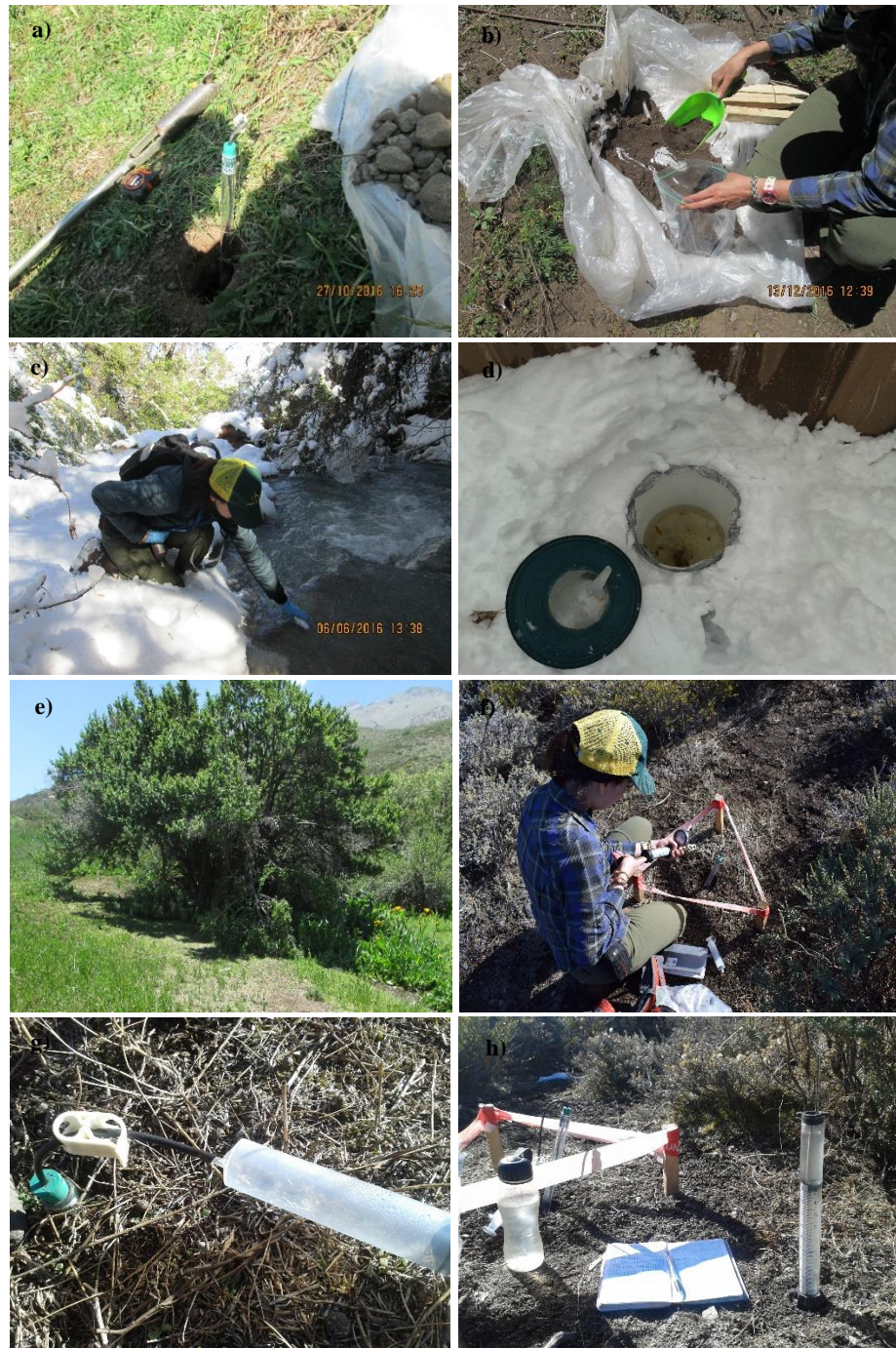
Figura 4.2 Principales actividades de terreno realizadas en la cuenca del estero Yerba Loca, a) Instalación de los lisímetros de succión, b) Toma de muestra de suelo del perfil excavado, c) Toma de muestra de agua en escurrimiento, d) Recolección de agua de precipitación caída en colectores, e) Sitio identificado como afloramiento, f) Aplicación de succión con bombín en lisímetros, g) Extracción de agua de poros del suelo y h) Pruebas de infiltración con el minidisco infiltrómetro.
