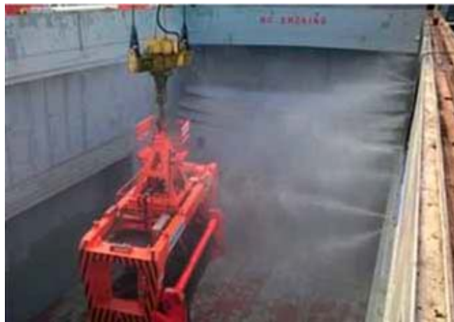
FIGURA N° 10: Neblina seca que inhibe la salida de concentrado durante la carga.
