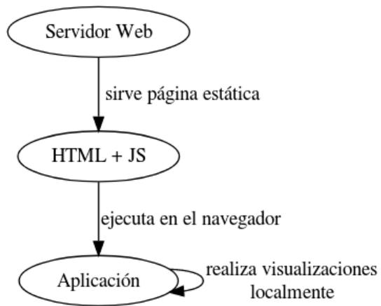
Figura 8.3: Funcionamiento de la aplicación web
