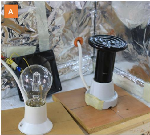
Figura 3. a) ampolletas y ventilador. b) bloque de acrílico sobre arena, con dos termopares, uno al interior y otro en la superficie
