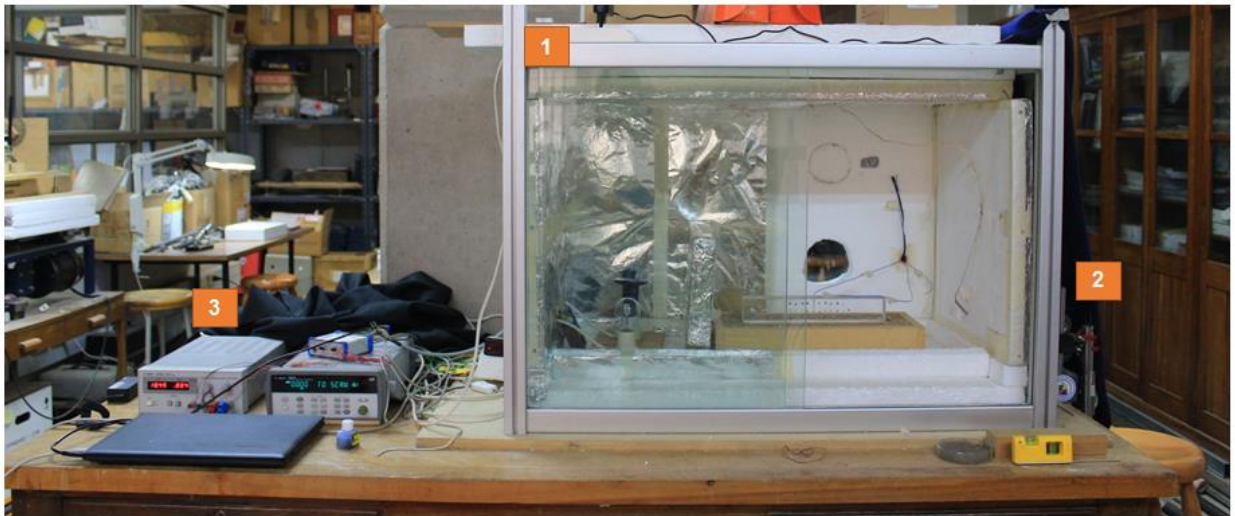
Figura 2. Montaje experimental. 1) cámara aislada térmicamente. 2) Sensores de desplazamiento LVDT y Láser. 3) Sistema de control y adquisición de datos y alimentación.
