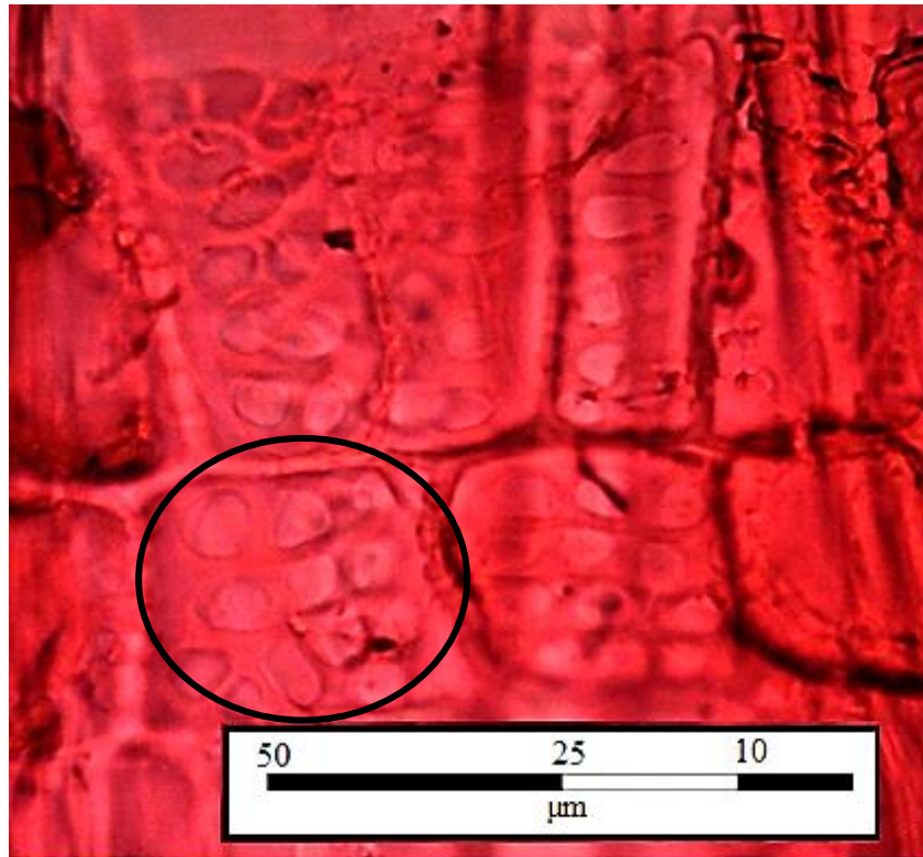
Figura 32: Punteaduras radiovasculares. Circunferencia indica un campo de cruce. Periodo C, altura 1,3, corte longitudinal radial (40x).
