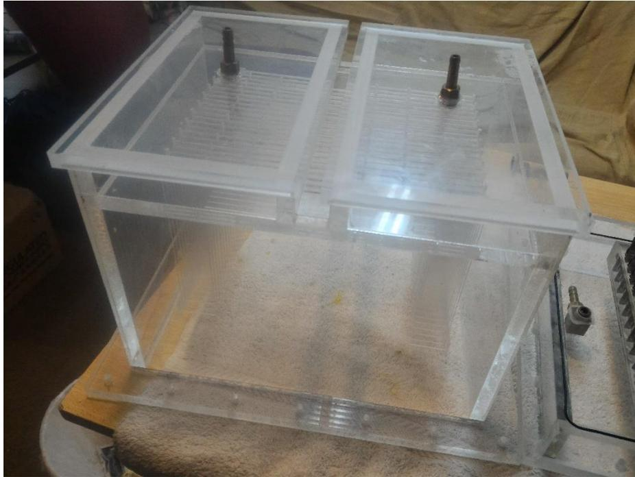
**Figura 3-42: Parte superior de la celda**
