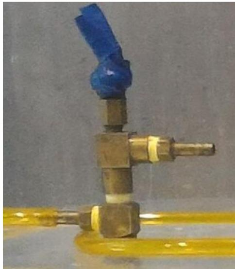
**Figura 3-45: Llave superior de los estanques**
