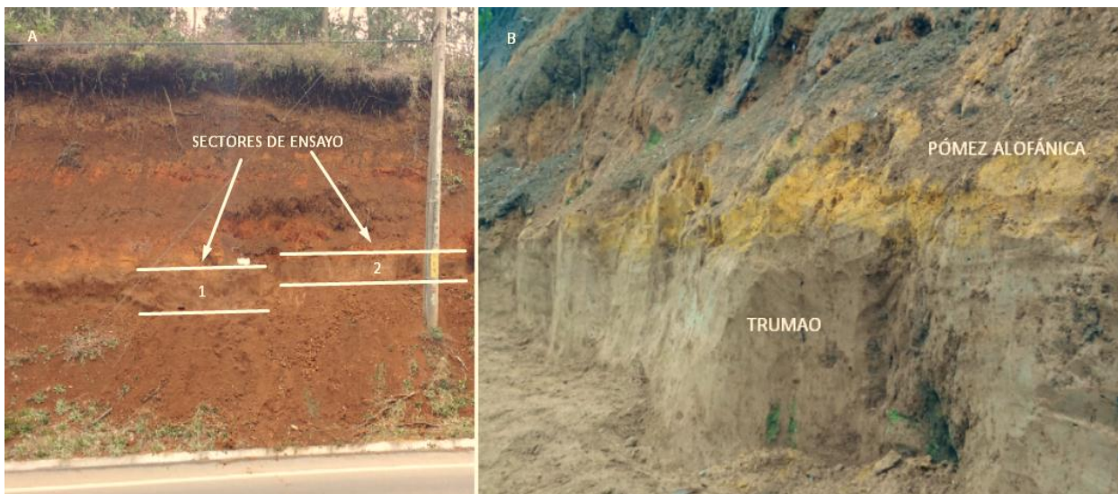
Figura 32 Segunda visita a terreno, A) Talud vista frontal, B) Contacto entre estratos.
