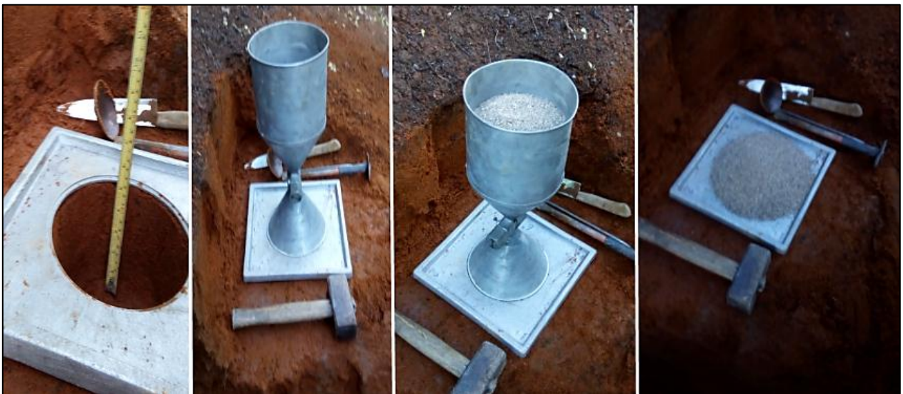
Figura 29: Aplicación del Método del Cono de Arena.
