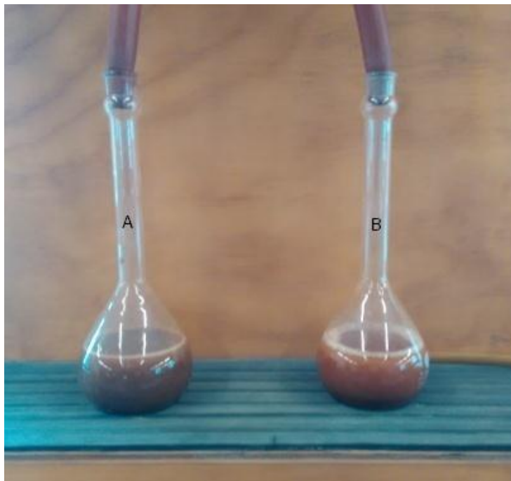
Figura 34: Aplicación de vacío a dos de los suelos; A) M-1 (Trumao), B) M-2 (Pómez Alofánica).
