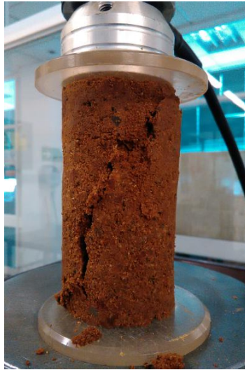
Figura 47: Probeta de M-4 (Pómez Alofánica) luego de la falla
