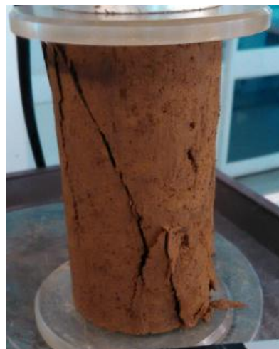
Figura 43: Probeta de M-1 (Trumao) luego de la falla.
