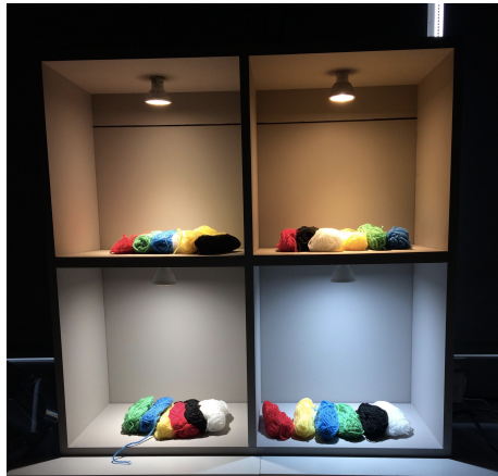
Caja de luz para comparar iluminantes y su efecto en la visión de color.
