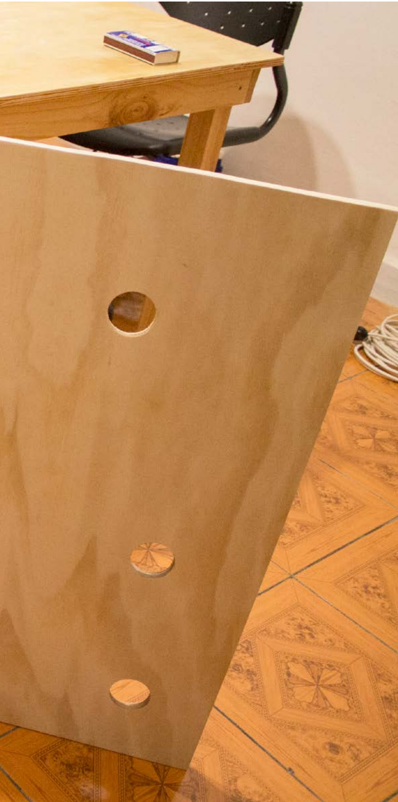
◀ DIAGRAMA VII Proceso de obra. Perforaciones para el montaje de parlantes.
