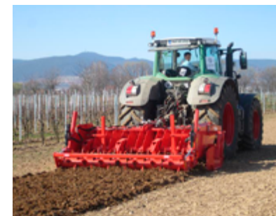
Imagen 32. Subsolador trabajando el terreno. (sirioagri.ro)
