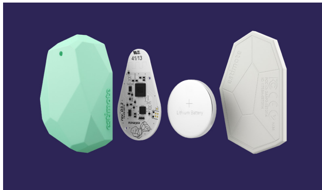
Imagen referencial de las partes de un Beacon Fuente: estimote.com
