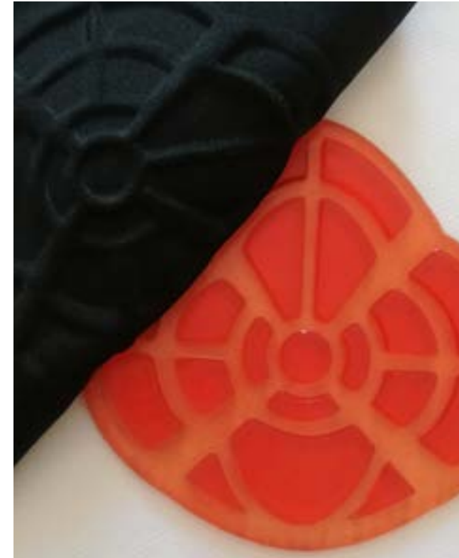
Figura 121: Área de protección pequeña revestida y luego despegada de su tela, para mostrar que la tela toma la forma de esta. Fuente: Elaboración Propia.
