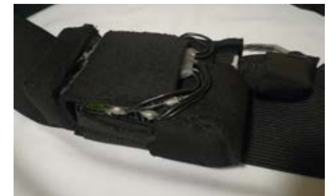
Figura 149: Detalle caja arduino UNO en cinturón Fuente: Elaboración propia.
