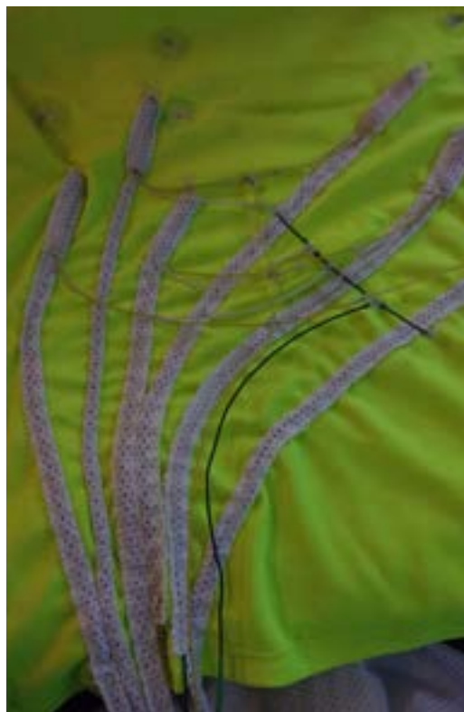
Figura 151 : Circuito Interno en camiseta de prueba. Fuente: Elaboración Propia.
