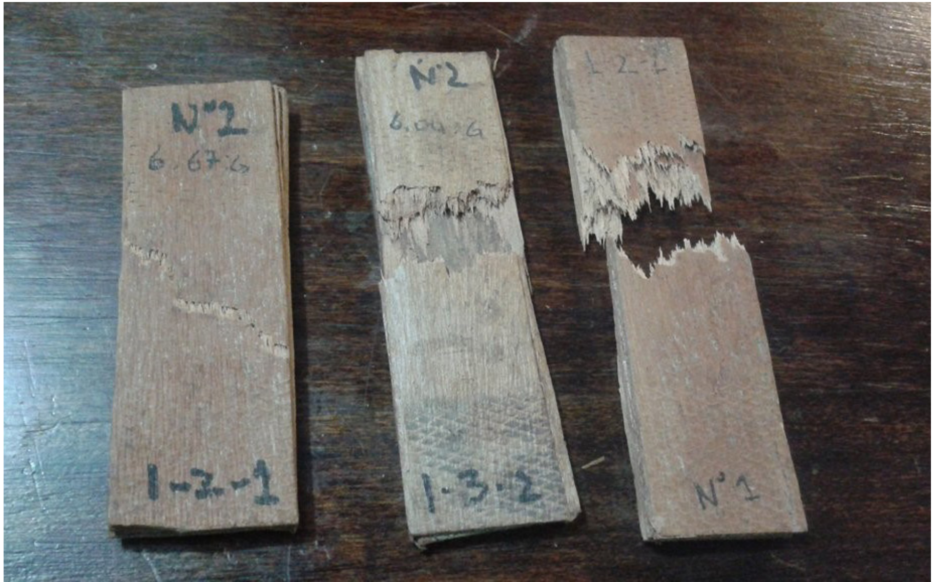
Rotura de Probetas.
