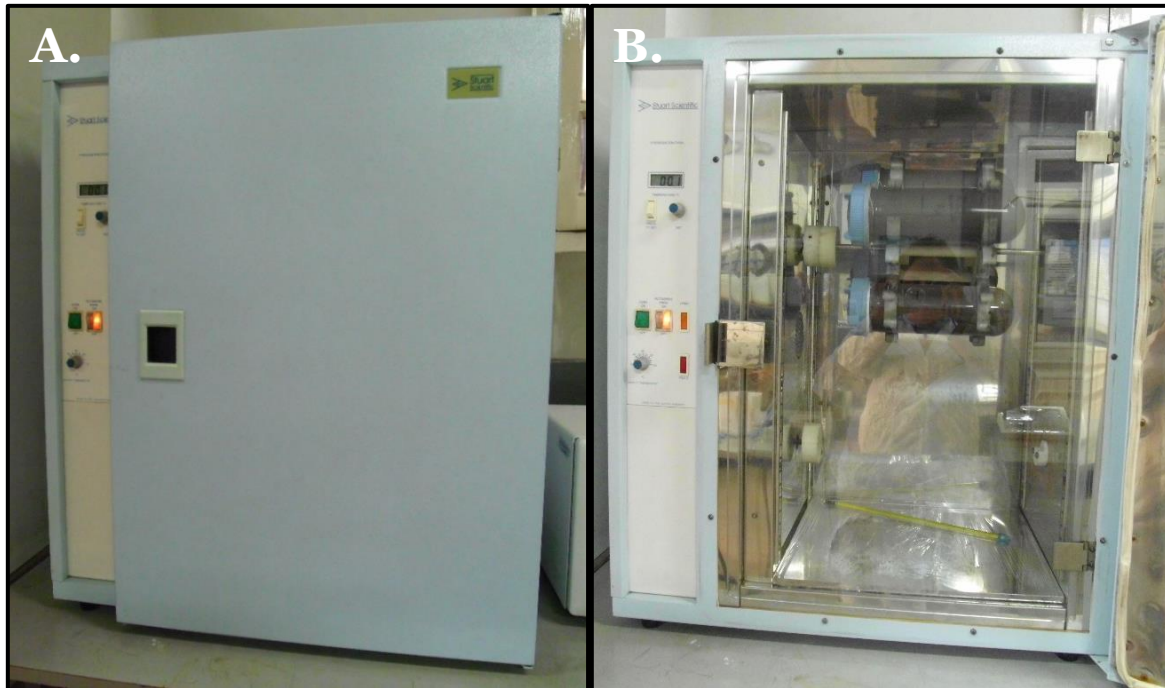
Ilustración 11: Horno de hibridación utilizado. A. Vista exterior del horno. B. Vista del interior del horno, con puerta exterior abierta y puerta interior de vidrio cerrada.
