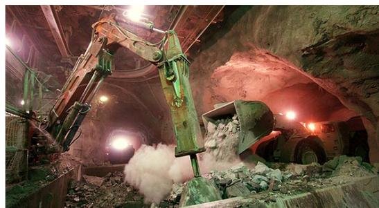
(b) Equipo LHD descargando mineral en el punto de vaciado, el cual está equipado con un martillo picador. *Fuente: Propia*
