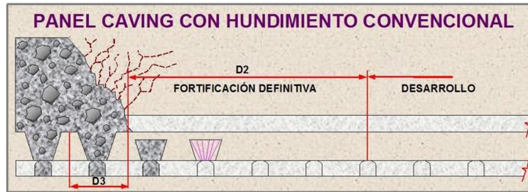
Figura 2.8: Vista de Perfil de la Variante Panel Caving con Hundimiento Convencional.
