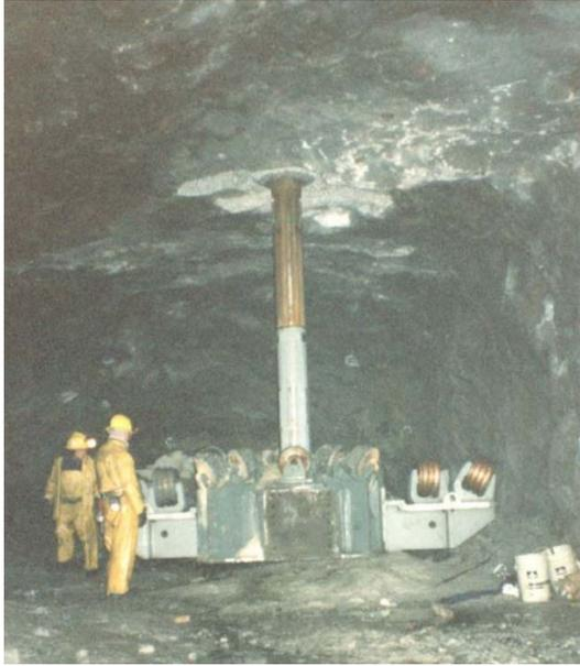
(a) Perforación Mecanizada con Equipo Raise Borer. *Fuente:(Contreras, 2007)*
