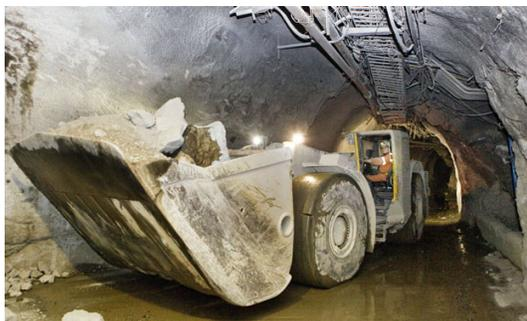
(a) Equipo LHD transportando mineral al punto de vaciado. *Fuente: Propia*
