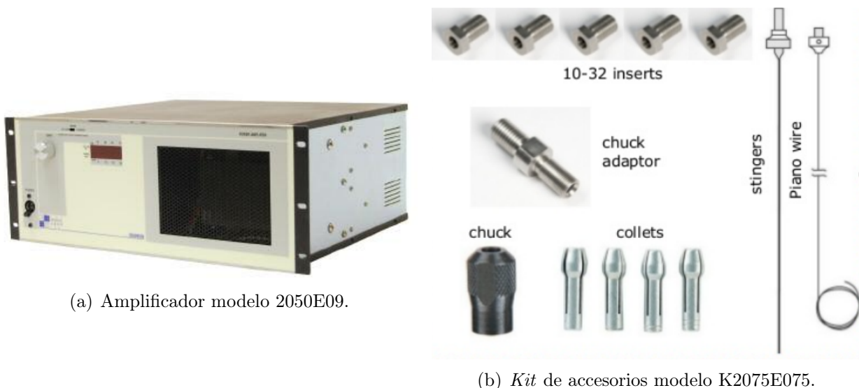
Figura 4.47: Selección acompañante del shaker dual modelo 2075E del fabricante The Modal Shop . Fuente imagen: The Modal Shop .
