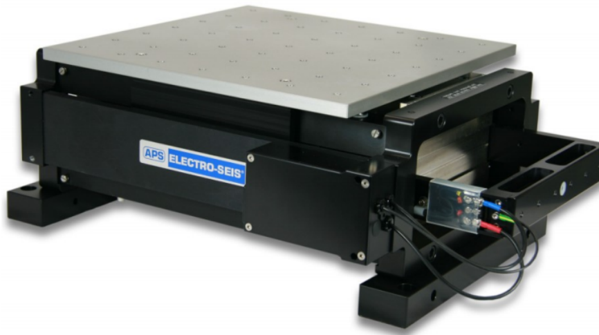
Figura 2.14: Mesa sísmica de 1 GDL APS Electro-Seis, desarrollada por el fabricante alemán APS. Fuente imagen: APS 400 ELECTRO-SEIS®.
