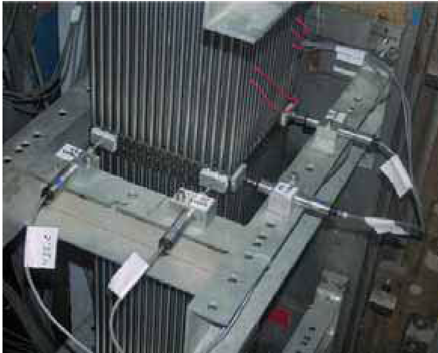
Figura 2.11: CALVA Bench: elemento combustible de potencia con sensores de deformación y desplazamiento. Fuente imagen: Areva [8].
