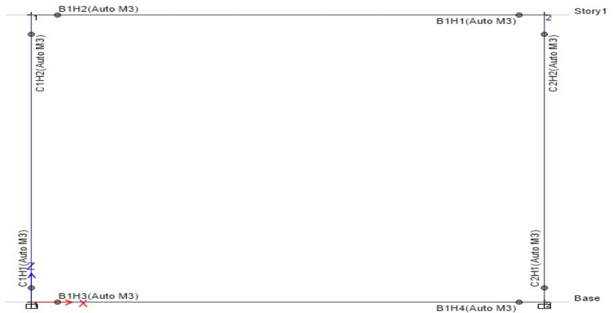
Ilustración 25: marco sin relleno considerando rotulas plásticas en ETABS.
