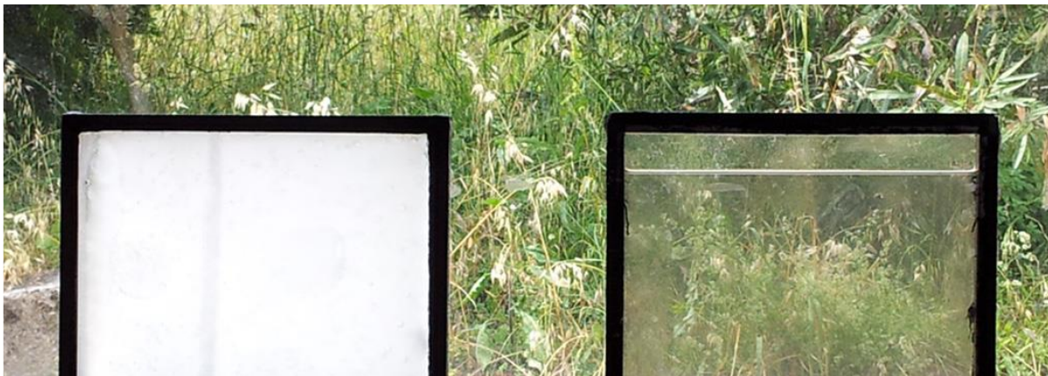
Figura 4 Dos ejemplos de ventanas con PCM, a la izquierda se ve el PCM en estado sólido y a la derecha en estado líquido, (Goia et al., 2015).
