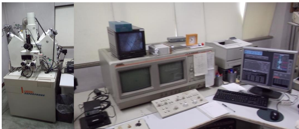
Figura 1.2: Fotografías de la microsonda utilizada para el análisis de biotitas. A la izquierda se aprecia la cámara de vacío donde se ingresa la muestra a analizar, la torre que genera el haz de electrones y los espectrómetros de masa, y a la derecha la interfaz para realizar los análisis.
