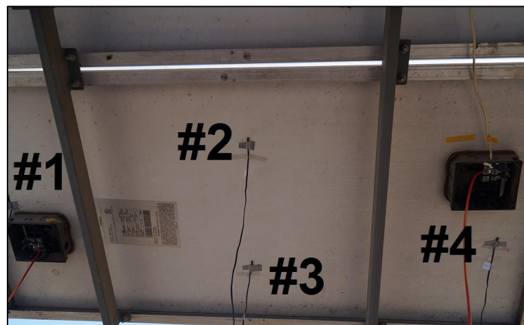
Figura 5-17: Notación de los sensores colocados en la parte posterior del módulo FV
