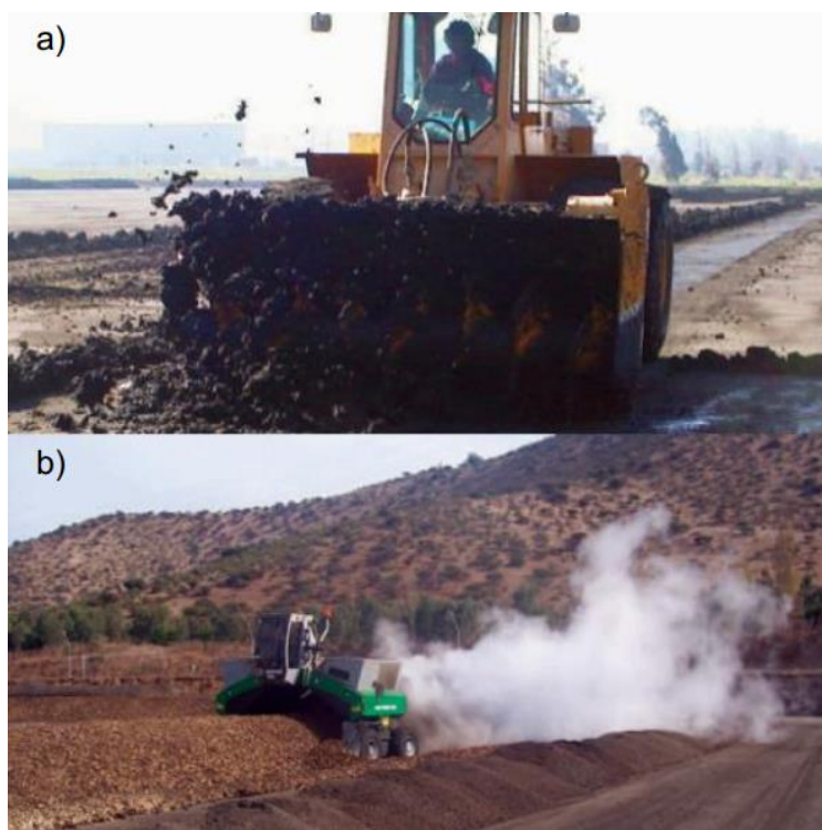
FIGURA 2: VOLTEO DE LODO: A) SECADO SOLAR, B) BIOSECADO
