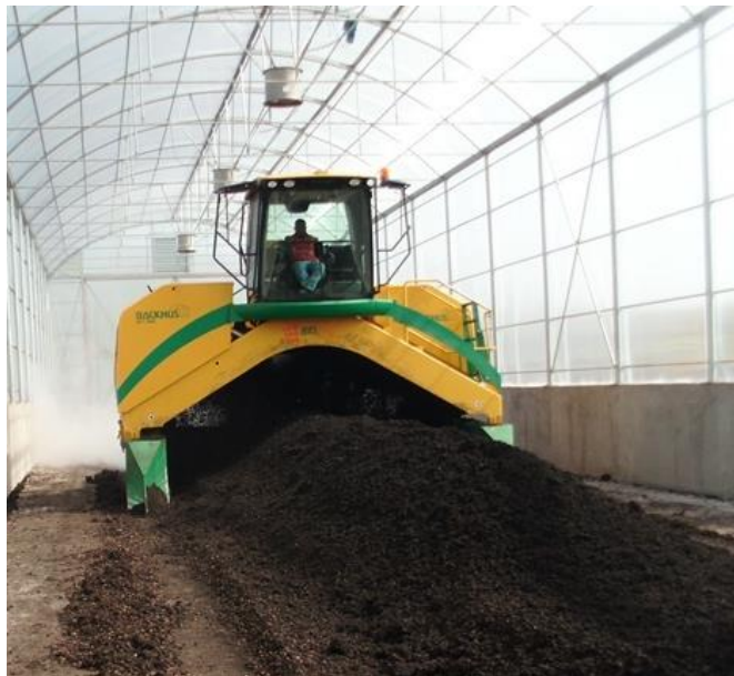
FIGURA 16: PILA DE LODO EN INVERNADERO DURANTE VOLTEO
