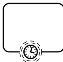
Figura 3.40: Evento Intermedio Adjunto No Interruptor Temporal Fuente: Elaborado por el autor en base a póster de BPMN 2.0.
