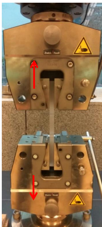
Figura 5.3: Ensayo de tracción a muestra normalizada. Fuente: Generación propia.
