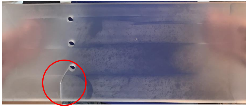
Figura 6.1: Probeta ensayada en flexión en 3 puntos hasta la falla, Fuerza máxima de 9,6[kN]. Fuente: Generación propia.
