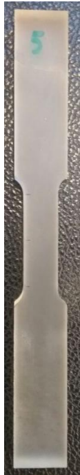
Figura 5.2: Muestra bajo norma ASTM D638, N°5 de 6. Fuente: Generación propia Ensayo de Tracción. Fuente: Generación propia.
