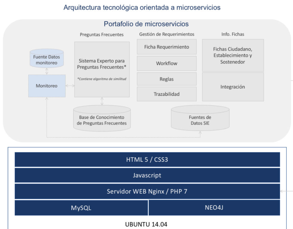
Figura 27: Arquitectura tecnológica orientada a microservicios de la SUPEREDUC Fuente: Elaboración propia.
