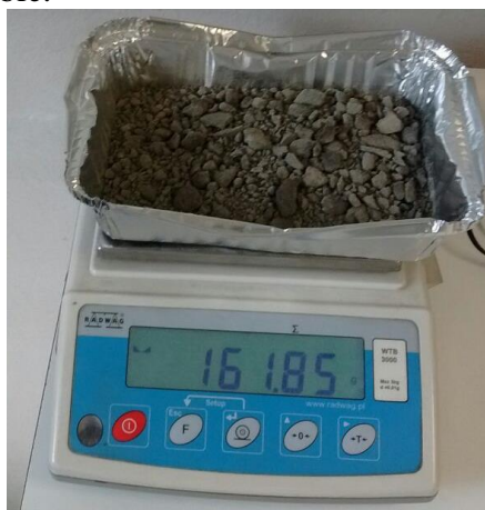
Figura 7: Registro del peso de la muestra tras el proceso de secado.
