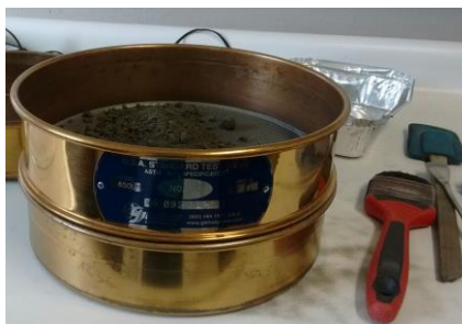
Figura 8: Disgregación de la muestra mediante el uso del tamiz número 20. A la derecha de la foto se puede observar la brocha y espátula de cocina utilizadas en este proceso.
