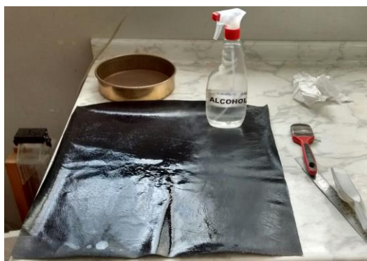
Figura 11: Limpieza del paño de cuero mediante el uso de alcohol.
