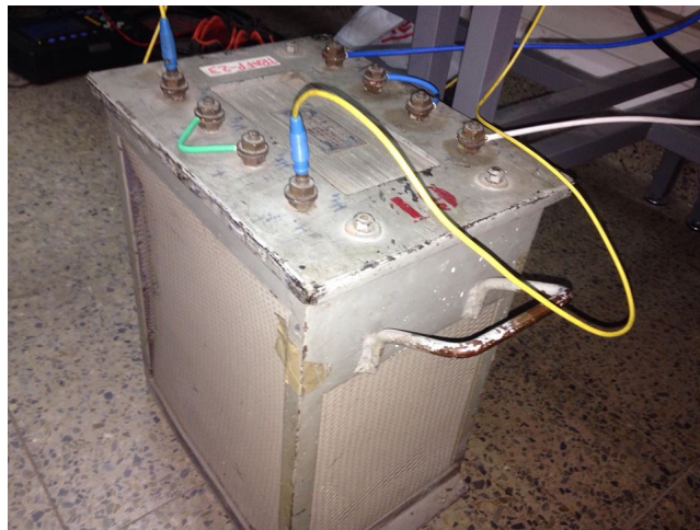
Figura 5.16: Transformador monofásico razón 2:1.
