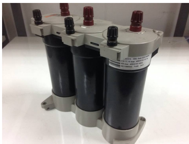
Figura 5.7: Banco de condensadores utilizados como filtro capacitivo.
