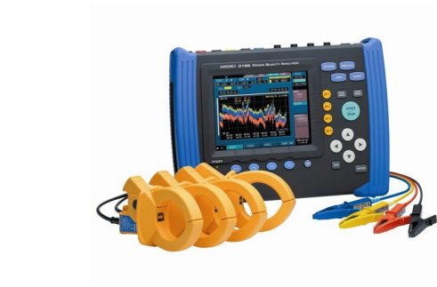
Figura 5.13: Analizador de calidad de potencia Hioki 3196.
