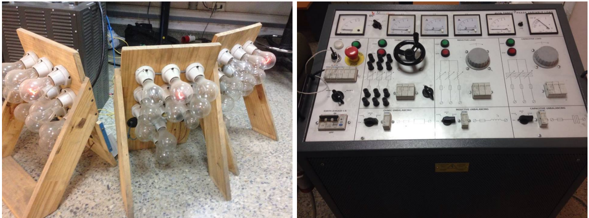
Figura 5.15: Arreglos de ampolletas utilizados como carga resistiva.
