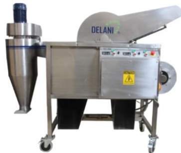
Ilustración 25 Descascarilladora de cacao (Windcraker-50)
