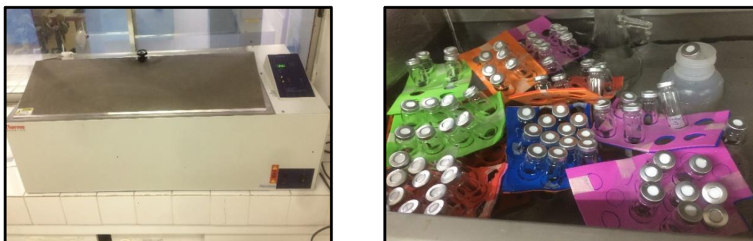
Figura 15. Muestras del ensayo de biorremediación dispuestas en el baño termostático.
