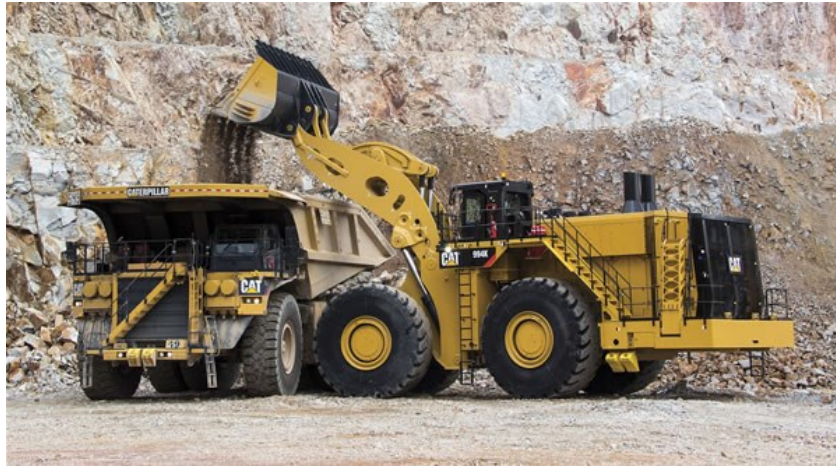
Figura 5.4. Posición Camión-Cargador para definir el ancho operacional
