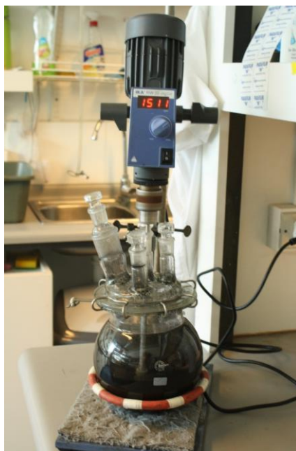
Figura 2: Reactor utilizado para la síntesis del mag-NanoSCH.
