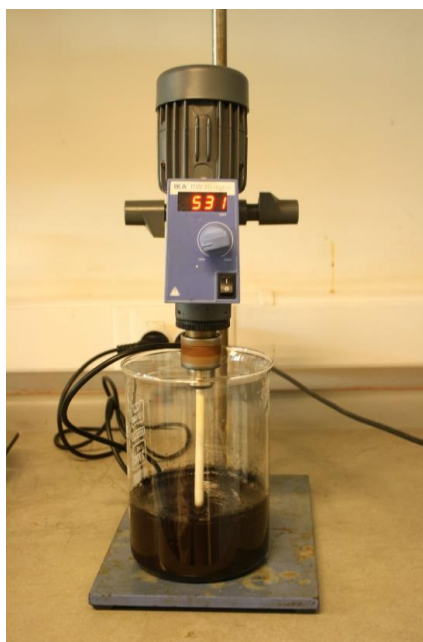
Figura 1: Reactor utilizado para la síntesis del mag-MnO 2 .
