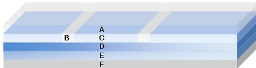
Fig. 1.2. Estructura tipo celda fotovoltaica: A: Encapsulante. B: rejilla de contacto. C: anti-reflectante. D: semiconductor tipo n. E: semiconductor tipo p. F: contacto posterior.
