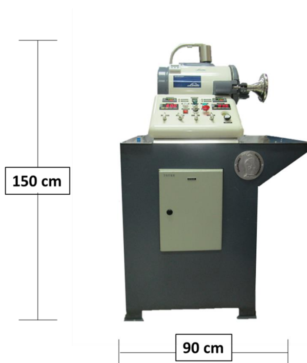
Figura 3: Imagen de la cámara hiperbárica experimental. Vista frontal de la cámara de HBOT en donde se realizaron las sesiones. Se observa el tablero de control en la parte frontal y las dimensiones de la máquina completa (150 cm x 90 cm). Cámara hiperbárica construida por empresa Osorio hermanos y Cia en colaboración con el laboratorio de la Dra. Palma.
