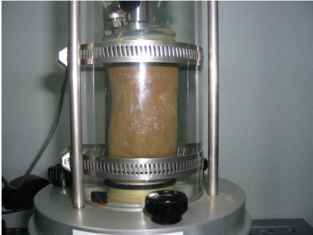
Ilustración 2. Ensayo de compresión triaxial (Figura extraída de Prodyogi).
