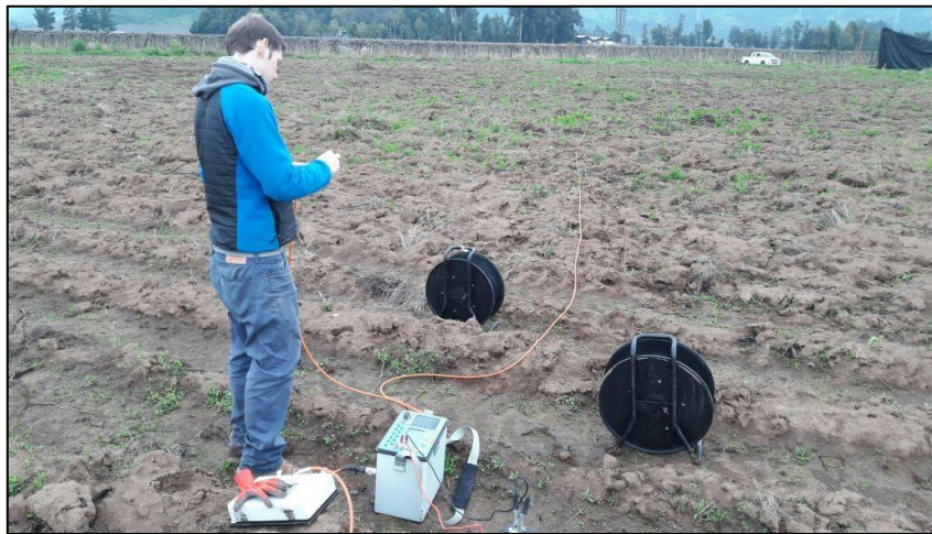
Figura 16: Medición de Tomografía de Resistividad Eléctrica. Elaboración propia.
