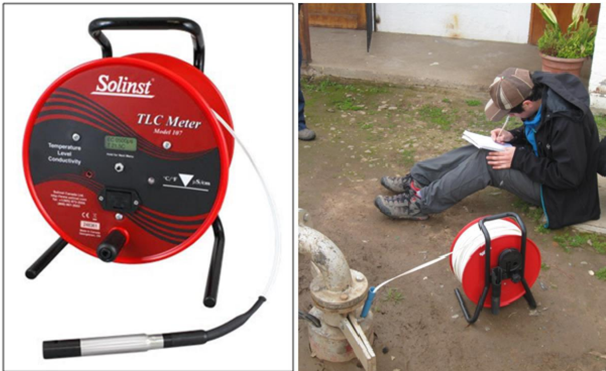
Figura 10: Izquierda: Freatómetro Solinst TLC 107. Derecha: Medición de nivel estático, temperatura y conductividad eléctrica del agua subterránea en un pozo. Elaboración propia.
