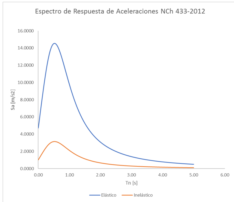
Figura 2.8. Espectro de Diseño "DE" para un amortiguamiento efectivo del 5%. (NCh 433-2012)
