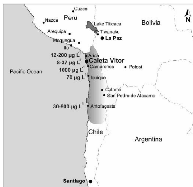
Fig. 5. Concentraciones de arsénico en medios acuosos en el norte de Chile (Swift et al., 2015).
