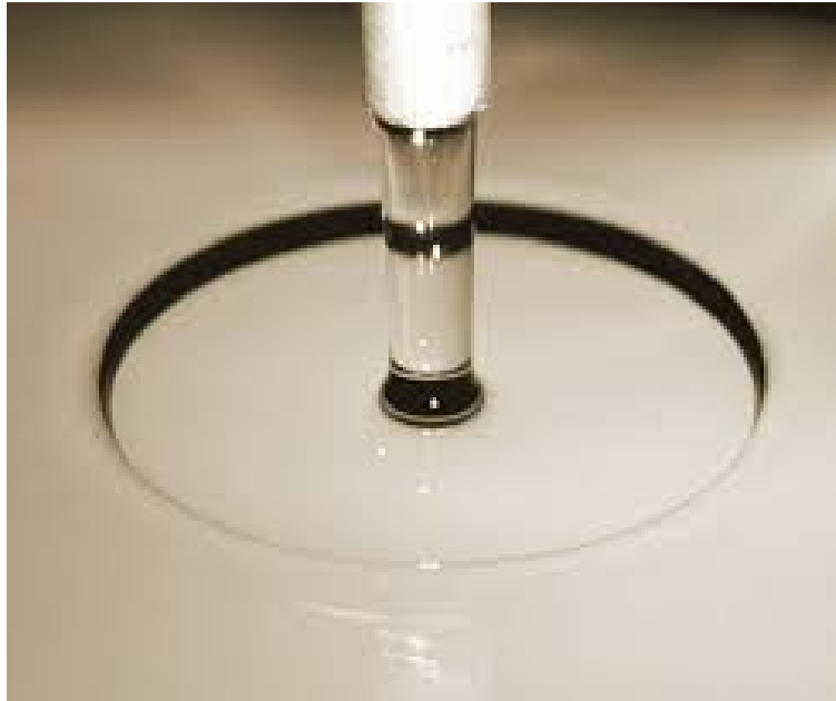
Figura 4: El salto hidrodinámico puede generar un horizonte para las ondas superficiales de agua. Al interior del salto hidráulico la velocidad del fluido es mayor que la velocidad de las ondas sin el flujo en contra. Si se envían ondas desde el exterior del salto hidráulico (para provocar una emisión estimulada), se apreciaría que una onda penetraría levemente al interior del anillo del salto hidráulico y otra saldría desde el salto alejándose de este, provocando el efecto descrito en la Figura 3. Referencia: [24]
